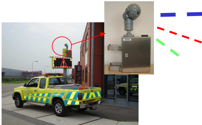
Auto camera met multiplexer en modems
